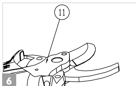
6. Posizionare la lama superiore nella direzione del numero seriale (11) come mostrato nell'immagine.
