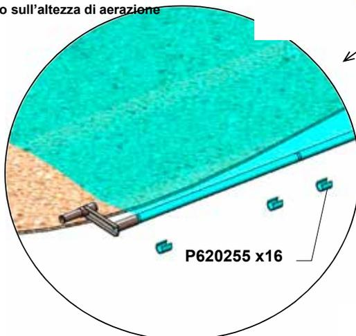
Le film doit être clipsé de manière la plus rectiligne possible
